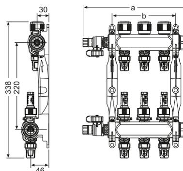
**Модуль подключения пластикового коллектора TECEfloor**
