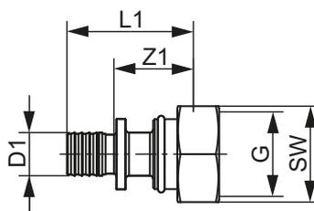
Соединение прямое TECEflex с накидной гайкой Евроконус 3/4" с пресс-соединением TECEflex, стандартная латунь
