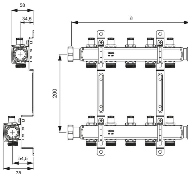
**Коллектор TECE из нержавеющей стали для систем отопления без индикатора потока и без запорных вентилялей**
