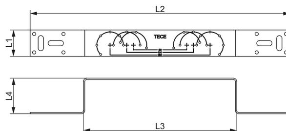
Монтажная трубка TECEflex для подключения радиаторов конечная, 15 мм, медная никелированная
