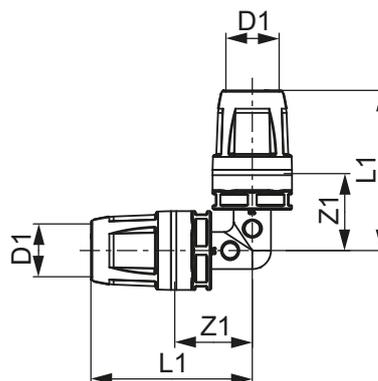
Уголок соединительный TECElogo-Push 90° системы push-fit, PPSU
