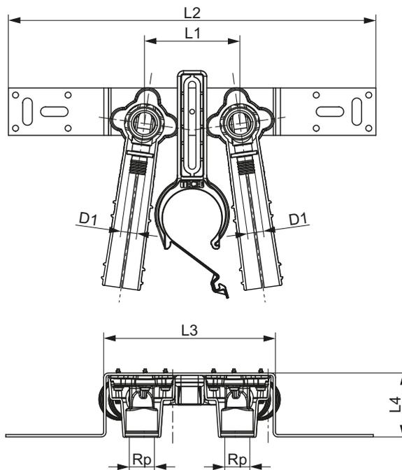
Монтажный комплект TECEflex с настенными уголками из бронзы/ кремнистой бронзы и шумопоглощающими элементами
