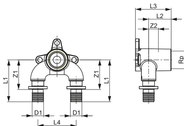
Тройник угловой редуционный с настенным креплением TECEflex, закругленный, с низким падением давления, бронза/кремнистая бронза
