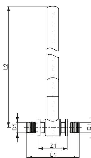
Монтажный узел TECEflex для подключения радиаторов, напольный, никелированный
