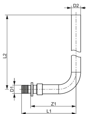
Монтажная трубка TECEflex для подключения радиаторов проходная, 15 мм, медная никелированная
