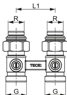
Запорно-присоединительный узел TECE для нижнего подключения радиаторов 1/2" МТ, угловой
