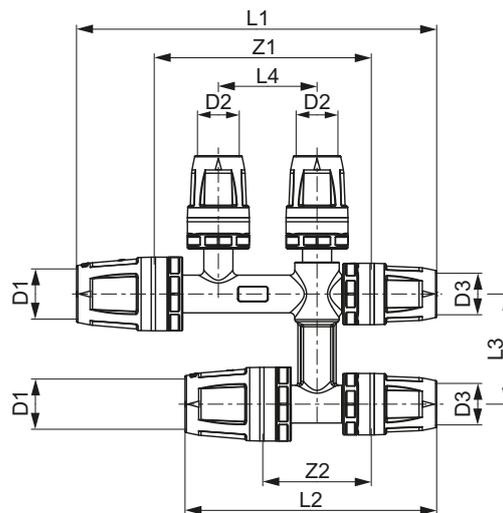
Монтажная трубка TECElogo для подключения радиатора
