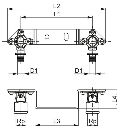
Монтажная заглушка TECE Seal System с клапаном заполнения и опорожнения, в комплекте с гидроизоляционной муфтой
