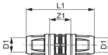
Соединение труба-труба TECElogo-Push редуцирующее, PPSU
