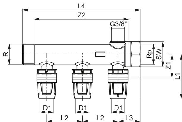
Коллектор TECElogo-Push, DR-латунь, плоское уплотнение, с накидной гайкой
